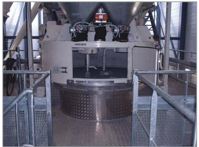
3. ábra: Integrált keverő- és mérlegszint, SKAKO Dynamix keverővel
